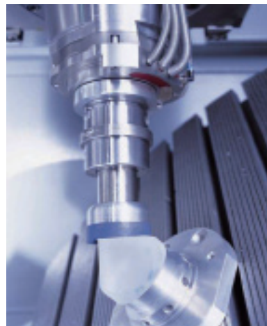
图9 超声波加工的激励系统
