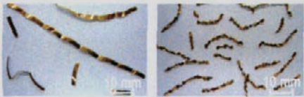
图10 电解铜的深孔钻削切屑
