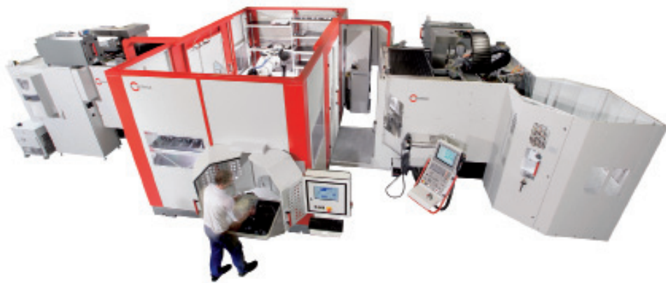
图8 连接两台加工中心的RS-2机器人系统
